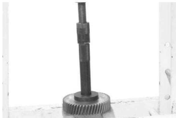
Ausbau der Büchse des oberen Zwischenrads
