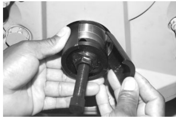
Ausbauwerkzeug für vorderen Verschleißring
