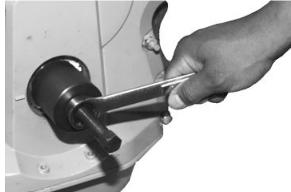
Abziehvorrückung für vorderen Verschleißring der Kurbelwelle
