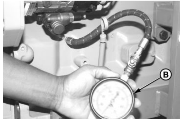
Manometer an Ölkanalanschluss
