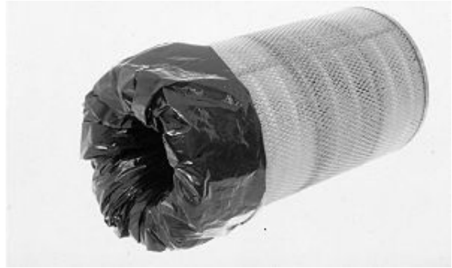
Luftansaugsystem-Leckprüfung
