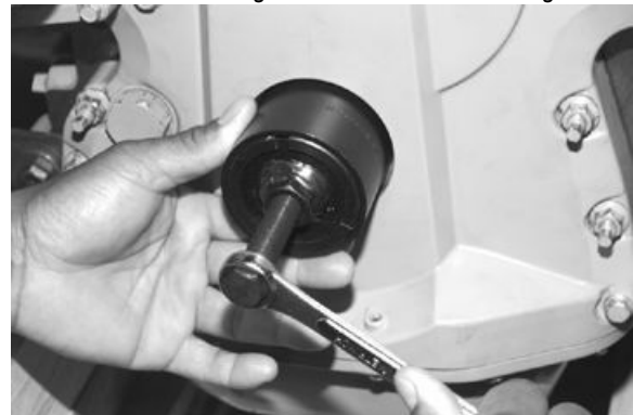
Ausbauwerkzeug für vorderen Verschleißring
