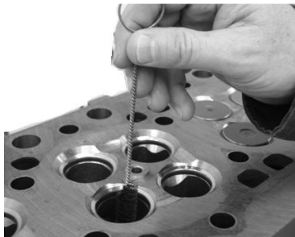
Reinigung der Ventileinführung
