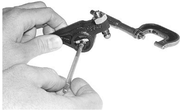
Kipphebelwellenbohrung-Innendurchmesser
