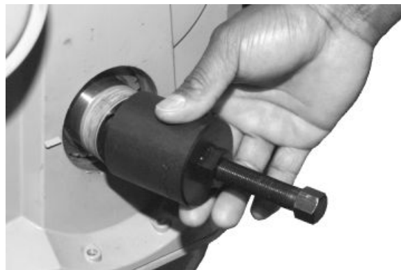
Abziehvorrückung für vorderen Verschleißring der Kurbelwelle
