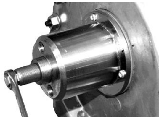
Kurbelwellenadapter und Druckschraube JDG1923A
