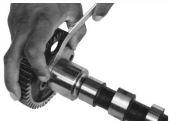
Messung des Spiels der Nockenwellen-Anlaufscheibe
