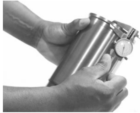
Messung der Büchsenflanschdicke
