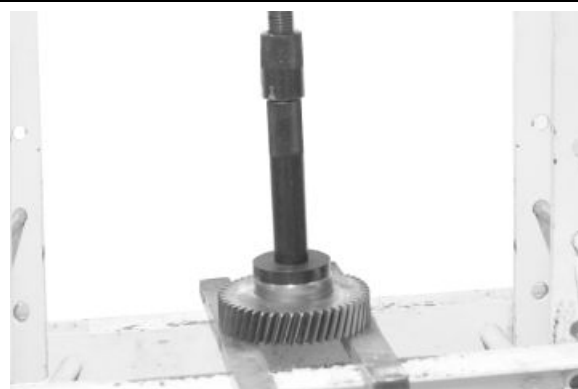
Einbau der Büchse des oberen Zwischenrads
