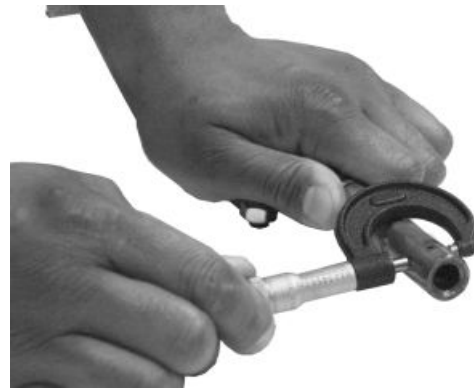
Kipphebelwellen-Außendurchmesser
