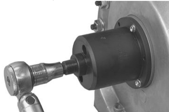
Ausbau des vorderen Öldichtrings
