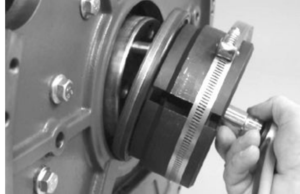
Ausbau des hinteren Öldichtrings
