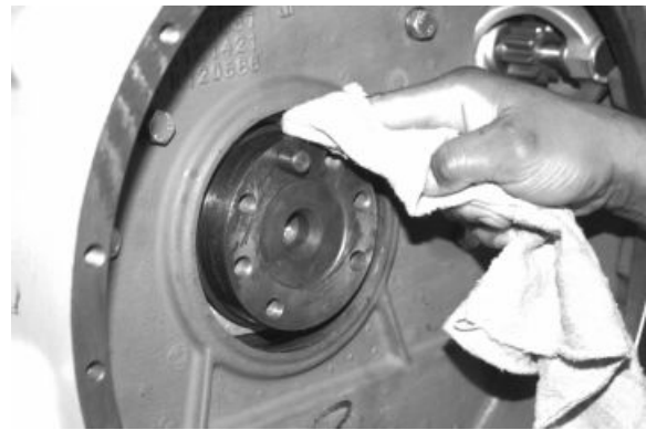
Reinigung des Kurbelwellenflansches
