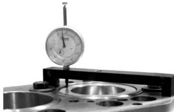
Messung des Kolbenüberstands
