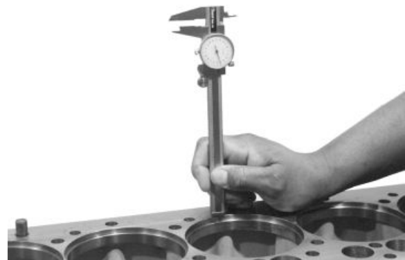
Tiefenmessung der Laufbuchsenflansch-Versenkung
