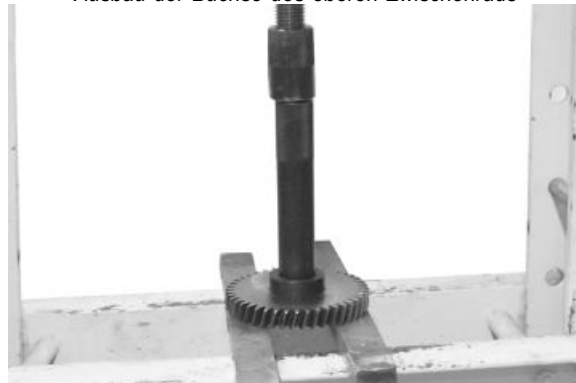
Ausbau der Büchse des unteren Zwischenrads
