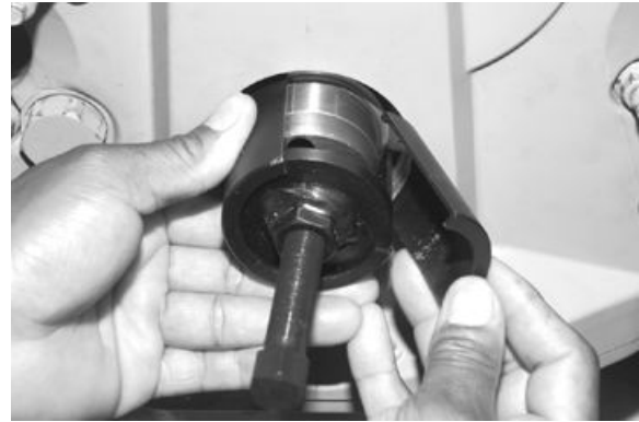
Ausbauwerkzeug für vorderen Verschleißring
