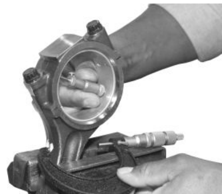
Messung des Pleuellager-Innendurchmessers (ID)
