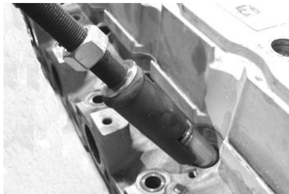
Die Einspritzdüsenhülse ausbauen.
