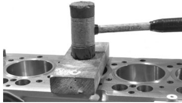
Einbau der Zylinderlaufbuchse
