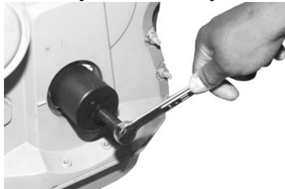
Abziehvorrückung für vorderen Verschleißring der Kurbelwelle
