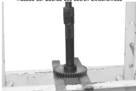
Ausbau der Büchse des unteren Zwischenrads
