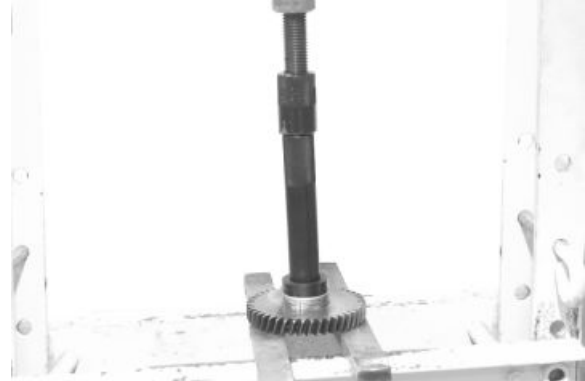
Einbau der Büchse des unteren Zwischenrads
