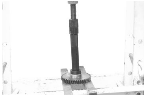
Einbau der Büchse des unteren Zwischenrads
