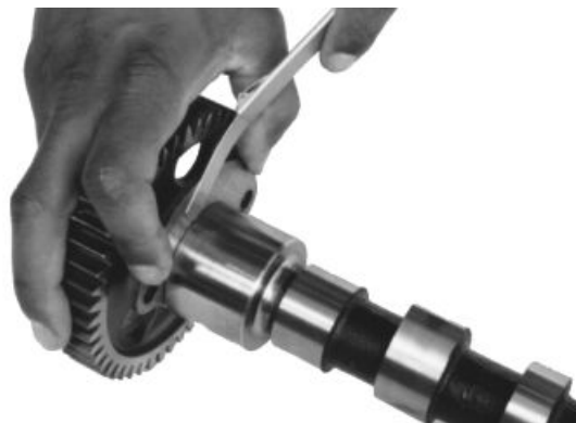
Messung des Spiels der Nockenwellen-Anlaufscheibe
