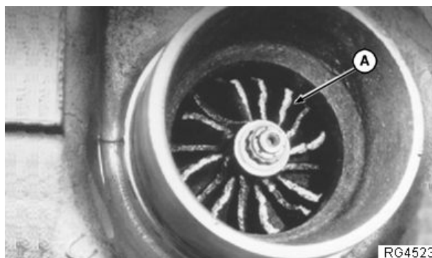
Überprüfung des Einlasses und Kompressorads
