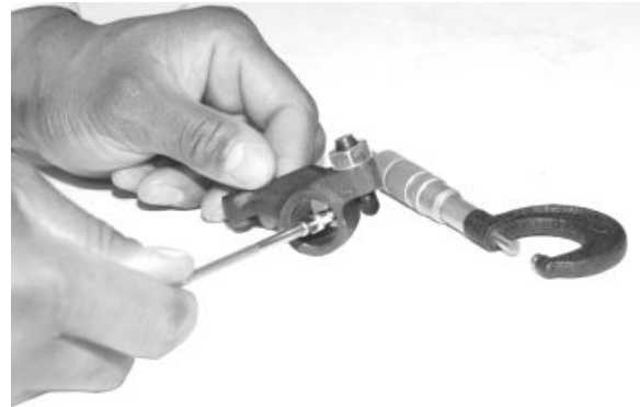
Kipphebelwellenbohrung-Innendurchmesser
