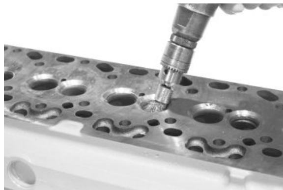
Reinigung und Untersuchung der Ventilsitze
