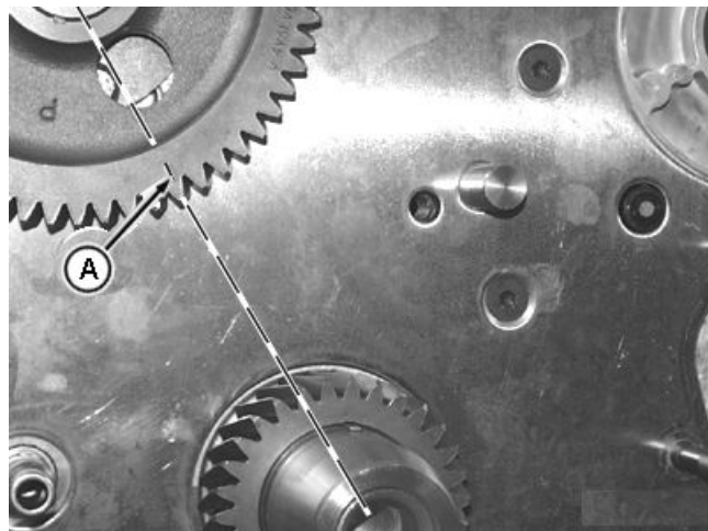
Ausrichtung der Einstellmarkierung
