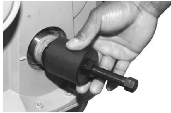
Abziehvorrückung für vorderen Verschleißring der Kurbelwelle
