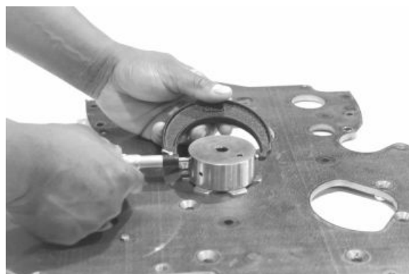
Messung des Außendurchmessers des Zwischenwellenzapfen
