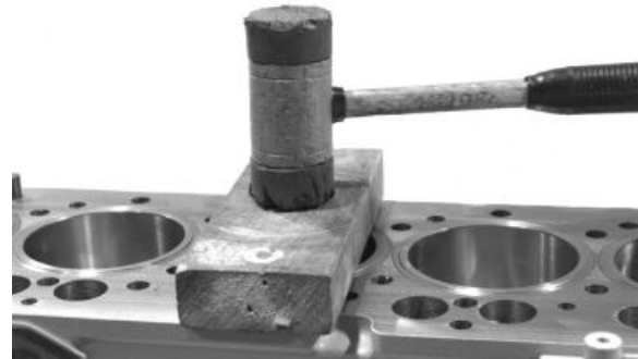
Einbau der Zylinderlaufbuchse
