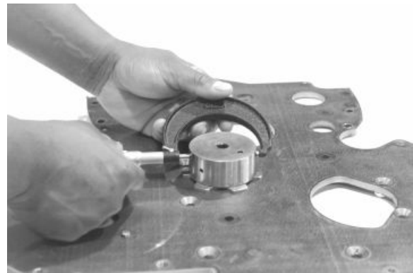
Messung des Außendurchmessers des Zwischenwellenzapfen
