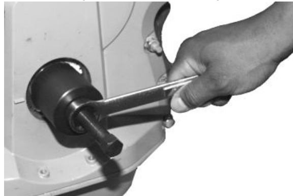
Abziehvorrückung für vorderen Verschleißring der Kurbelwelle
