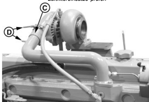
Prüfung der Turbolader-Lufteinlassschläuche
