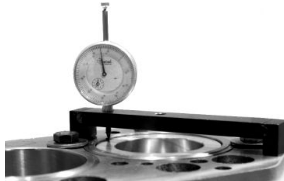
Messung des Kolbenüberstands
