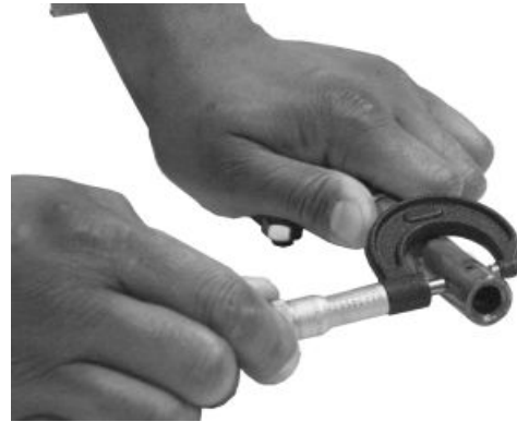
Kipphebelwellen-Außendurchmesser
