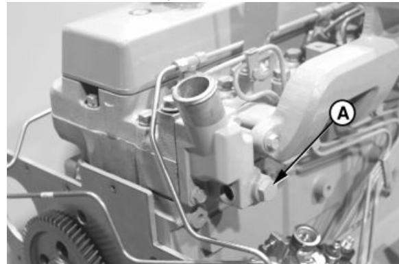
Thermostatgehäuse prüfen
