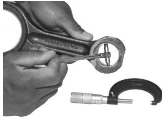
Messung des Innendurchmessers der Pleuelbolzenbohrung
