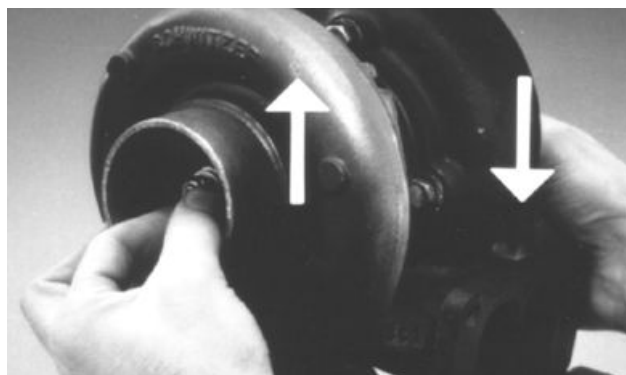
Prüfung auf Kontakt der Kompressor- und Turbinenräder
