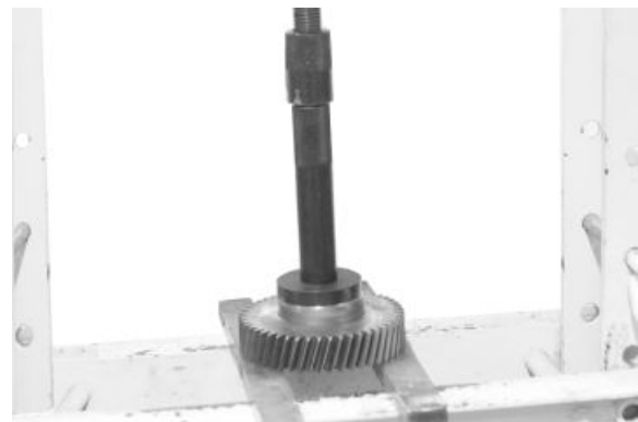
Einbau der Büchse des oberen Zwischenrads
