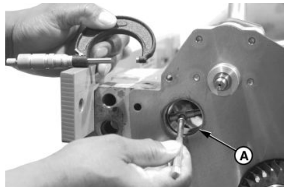
Messung des Innendurchmessers der Ausgleichswellenbüchse
