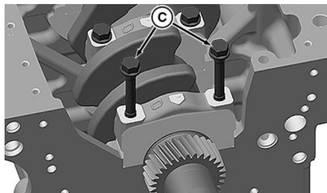
Schrauben der Kurbelwellen-Lagerdeckel
