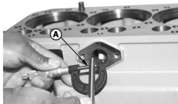
Messung der Stößelstange der Kraftstoffförderpumpe
