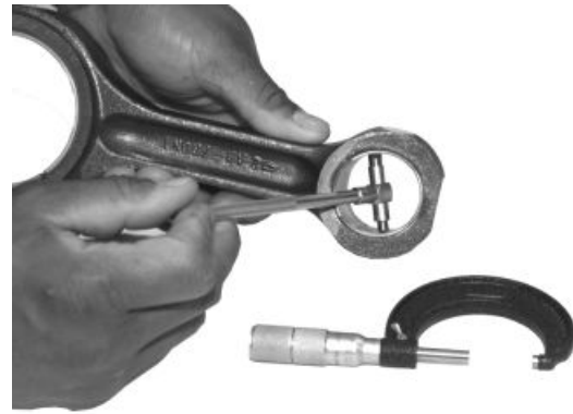
Messung des Innendurchmessers der Pleuelbolzenbohrung
