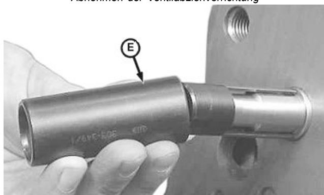
Abnehmen der Ventilabziehvorrichtung und der Hülse
