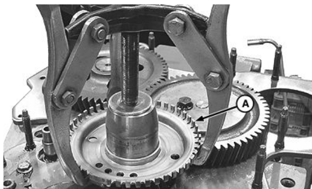
Steuerrad und Abziehvorrichtung
