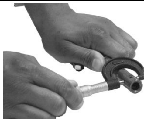
Kipphebelwellen-Außendurchmesser
