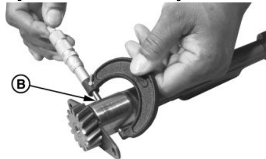
Messung des Innendurchmessers der Ausgleichswellenbüchse
