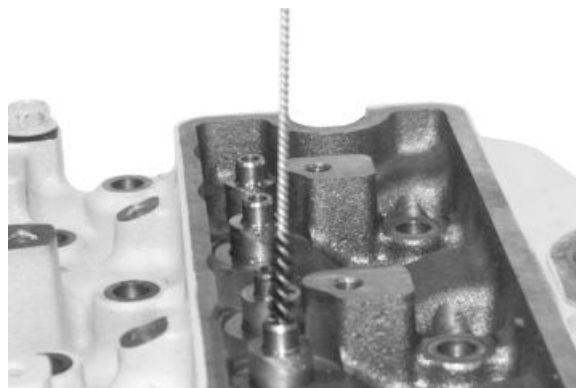
Reinigung der Ventileitung
