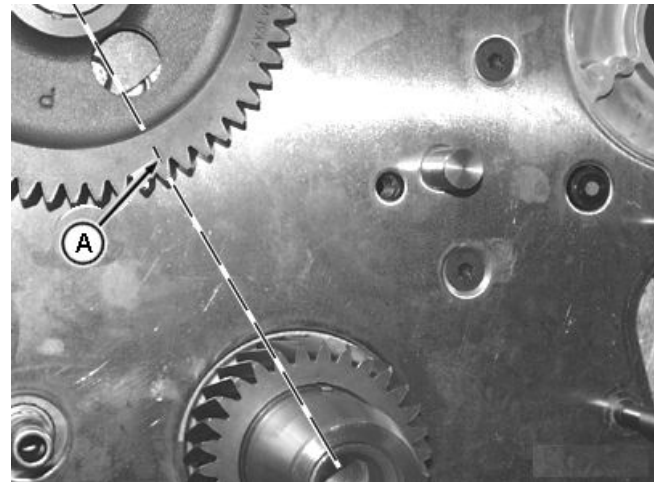
Ausrichtung der Einstellmarkierung
