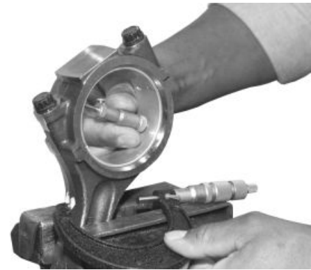
Messung des Pleuellager-Innendurchmessers (ID)
