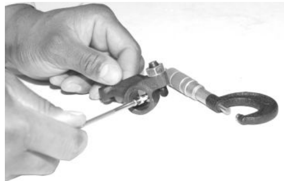
Kipphebelwellenbohrung-Innendurchmesser
