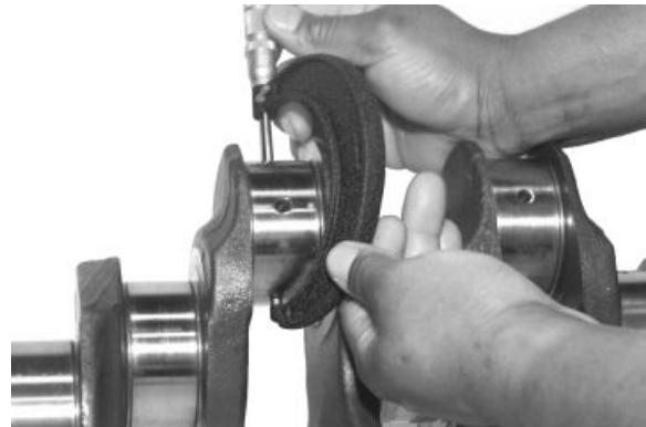
Messung des Kurbelwellen-Pleuellagerzapfens
