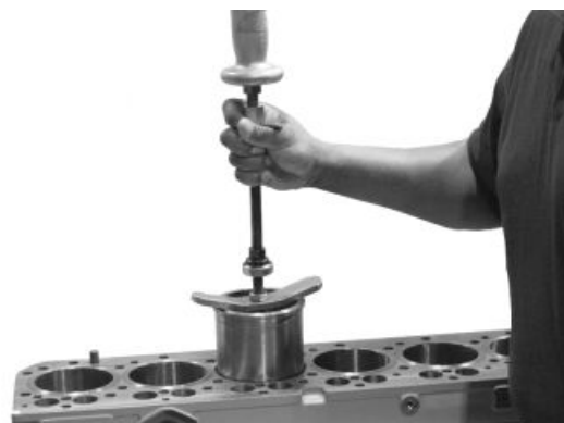
Herausziehen der Zylinderlaufbuchsen aus dem Block
