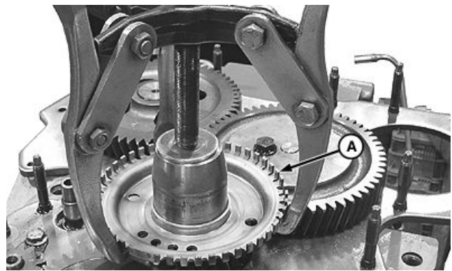
Steuerrad und Abziehvorrichtung
