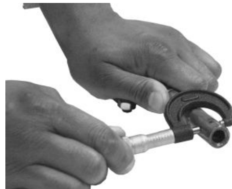
Kipphebelwellen-Außendurchmesser
