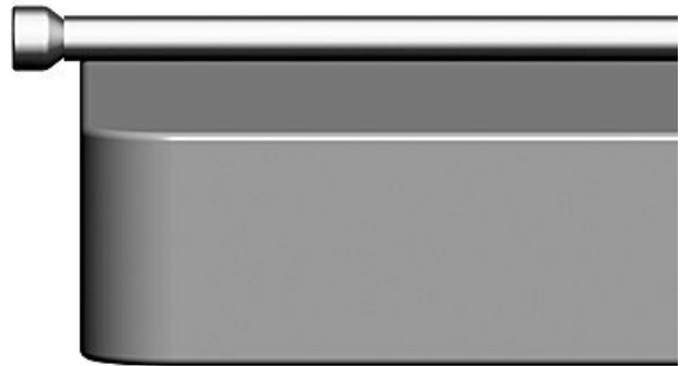
Prüfung der Ventilstößelstangen auf Geradheit
