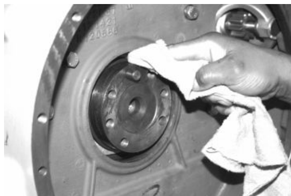
Reinigung des Kurbelwellenflansches
