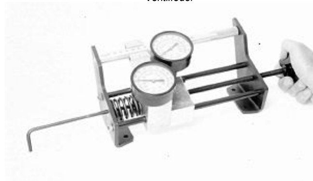
Prüfung der Ventilfederspannung
