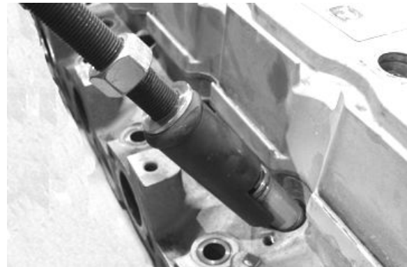
Ausbau der Einspritzdüsenhülse
