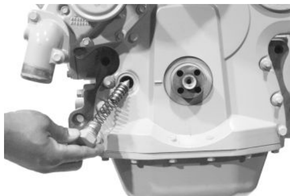
Öldruckreguliventil und Feder
