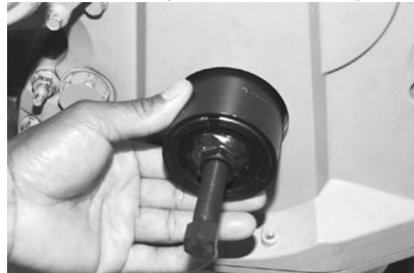
Ausbauwerkzeug für vorderen Verschleißring
