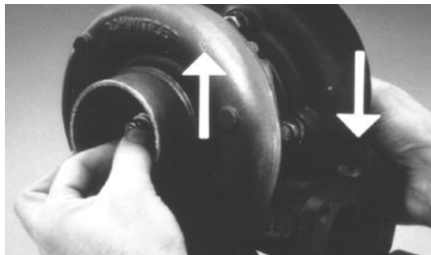
Prüfung auf Kontakt der Kompressor- und Turbinenräder
