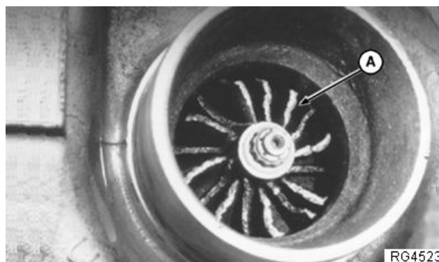
Überprüfung des Einlasses und Kompressorads
